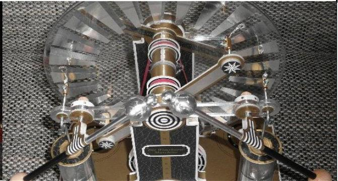
diese Wimshurstmaschine habe ich gebaut, ca. 20 000 Volt Hochspannung werden erzeugt und lassen die Funken knallen....
